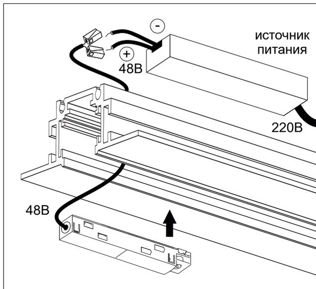
Рекомендации при монтаже профиля АД-5442. Убедительная просьба учитывать усилие при закручивании шурупов. Иначе это может привести к деформации и сужению профиля. Обязательно убедитесь что светильники беспрепятственно и без усилий входят в трек. Только после этого приступайте к шпаклевке.
